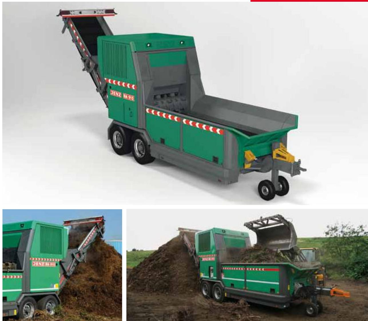
Машины для заготовки биомассы на полуприцепе со сцепной петлей
